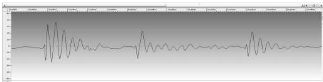
Рис. 6 – Типичная сейсмограмма разрушения образца угля в условиях одноосного сжатия
